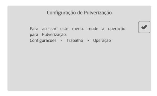
Estando com a <u>Operação</u> configurada para "Pulverização", será apresentado o menu das configurações do implemento de pulverização, chamado de "Configuração de Barra".
