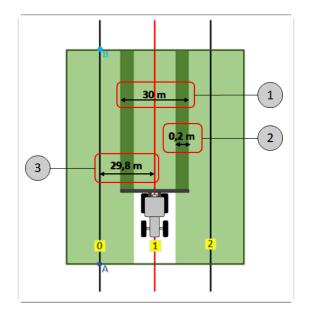
Para configurar o parâmetro de sobreposição, pressione o botão de "Editar" e será exibida uma tela do tipo Edição de Valor com Figura contendo uma imagem autoexplicativa, onde deve ser inserido o valor desejado para a sobreposição.
