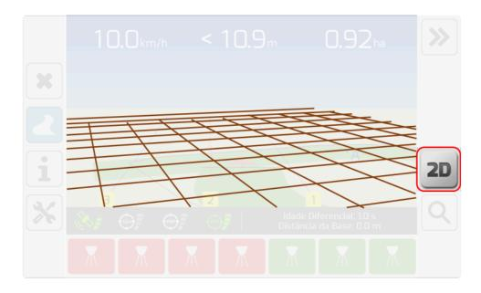
O botão perspectiva , destacado na figura, pode ser utilizado para alternar entre as duas perspectivas.
