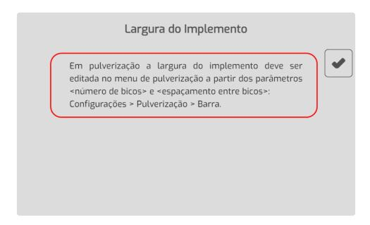
3) Se a <u>Operação</u> for diferente de "Pulverização", será exibida uma tela do tipo <u>Edição de</u> <u>Valor com Figura</u> da largura do implemento, conforme a imagem a seguir.
