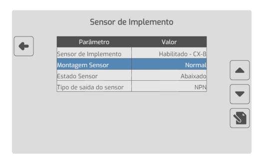
A tela do subparâmetro "Montagem Sensor" é então apresentada com as opções de montagem.
