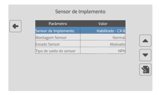
3.1) O subparâmetro **Montagem Sensor** é uma configuração utilizada para informar ao sistema IsoView a lógica de detecção do sensor indutivo.
