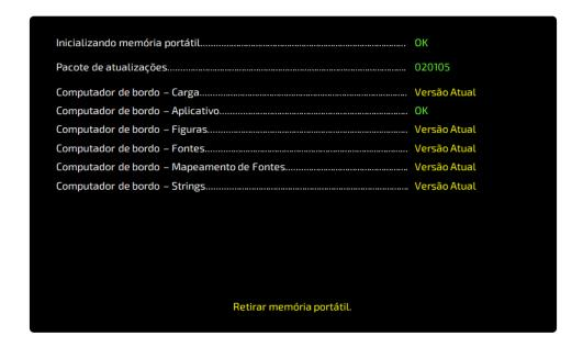
4.5) Desconecte a memória portátil do conector USB, fazendo com que o monitor desligue automaticamente.
