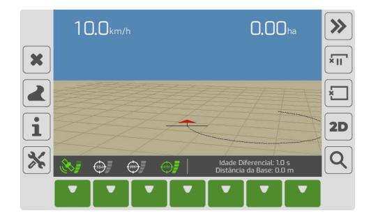
Durante a marcação do limite, é utilizado uma linha tracejada partindo do meio do implemento e no momento do fechamento do limite, esta linha é convertida em uma "linha sólida", e também pode ocorrer um deslocamento da linha de limite, caso esteja utilizando um limite do tipo barra ou personalizado, para a ponta da barra ou para a distância personalizada.
