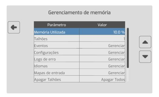
🖈 O valor da memória utilizada de fábrica para o monitor IsoView é de 10%, que incluem os arquivos de sistema necessários para o correto funcionamento do equipamento.
