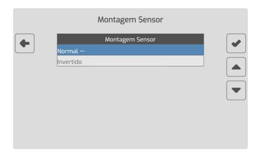
3.2) O subparâmetro Estado Sensor representa o estado de leitura do sensor indutivo, dependendo da montagem escolhida. A tabela a seguir mostra o valor do "Estado Sensor" de acordo com a detecção da superfície metálica pelo sensor indutivo, e com a configuração da montagem do sensor.
