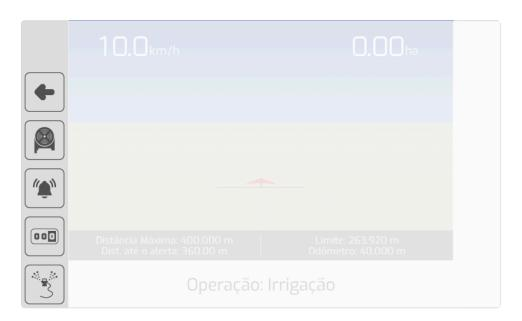
4.3) Pressione o botão de distância máxima para configurar o comprimento total da mangueira. Por exemplo, para a unidade de medida métrica, os valores ficam entre 1.000 e 2.500 metros.
