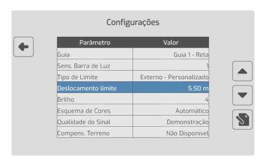
Com exceção do <u>Limite do tipo Projeto</u>, a demarcação do limite deve ser realizada percorrendo diretamente o perímetro do talhão com o equipamento agrícola.
